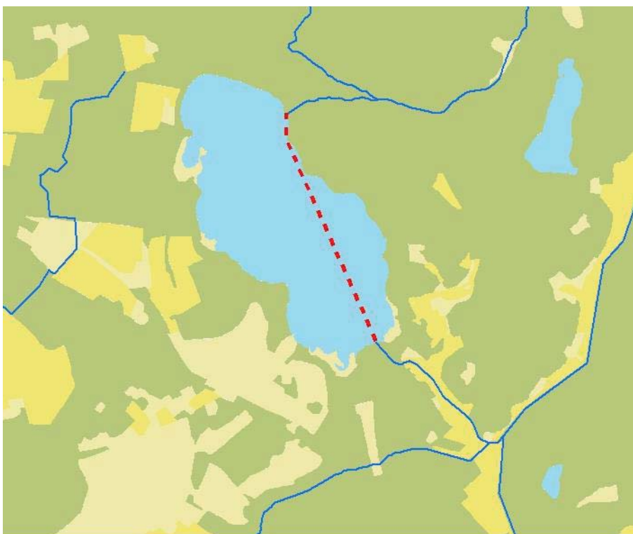
Figur 4. Exempel på dimensionerande transportsträcka (streckad) i mindre sjöar. ©Lantmäteriet. Ärende nr MS2011/02599.
