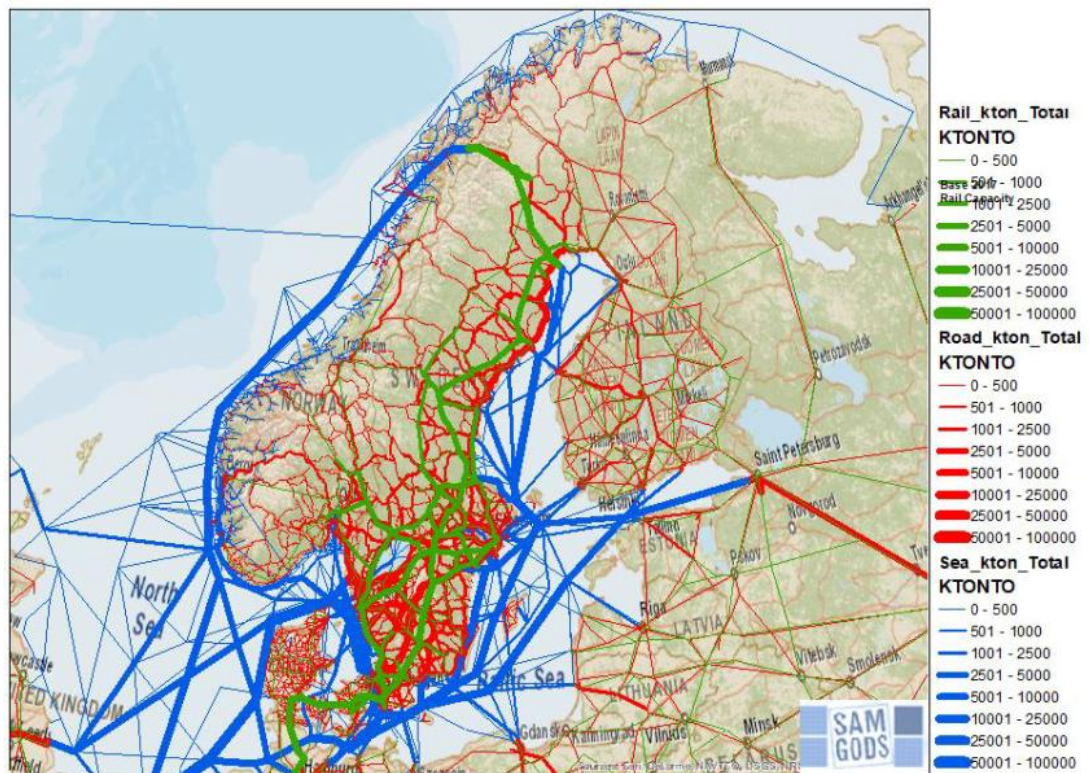
Figur 2.1: Modellberäknade godsflöden år 2017. Sjöfart (blå), järnväg (grön) och väg (röd). Tusentals ton per år. Källa: Prognos för godstransporter 2040 -Trafikverkets Basprognoser 2020 s.38
