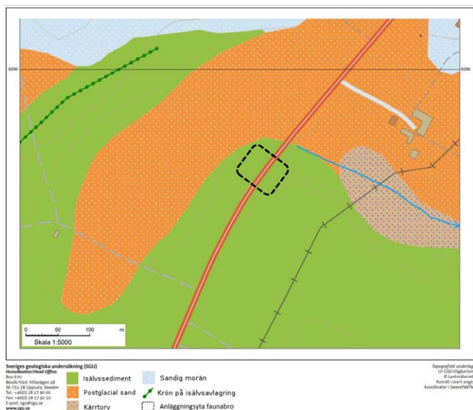
Figur 47. Jordartskarta över föreslaget område för anläggande av en faunabro, läge 123, Älvasjö. Anläggningsytan är ungefärlig. Källa: SGU kartvisare, hämtad 2020-09-21.
