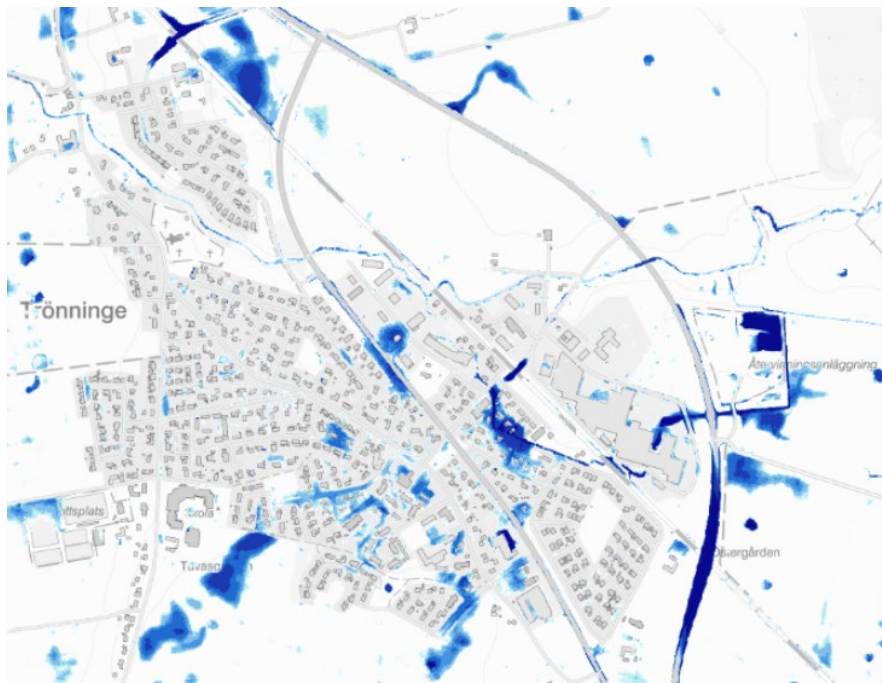
Figur 15:12. I Trönninge finns betydande risk för översvämning för befintlig bebyggelse och näringslivet vid kraftigt regn/skyfall, där det i vissa fall är risk för liv. Även samhällsviktig verksamhet kan påverkas av översvämning. Det pågår ett arbete med att anlägga en dagvattendamm vid skolan i Trönninge för fördröjning av dagvatten (inklusive kraftigt regn/skyfall) som till stor del bekostas av EU-projektet LIFE Goodstream.
