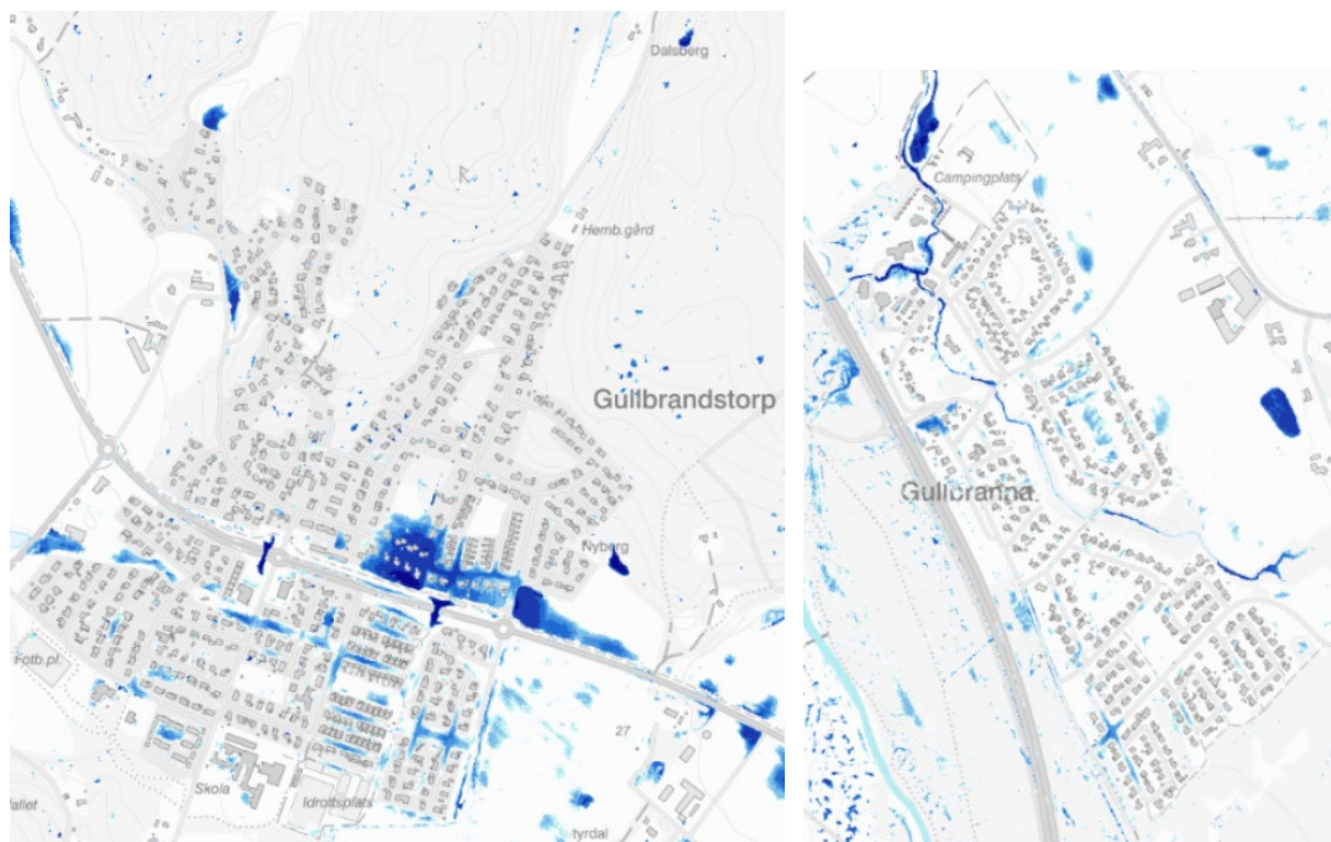
Figur 15:4. I Gullbrandstorp finns betydande risk för översvämning för befintlig bebyggelse vid kraftigt regn/skyfall, där det i vissa fall är risk för liv utefter kustvägen. Även samhällsviktig verksamhet kan påverkas av översvämning. Gullbranna klarar sig relativt bra och endast en liten del av den befintliga bebyggelsen riskerar översvämning.
